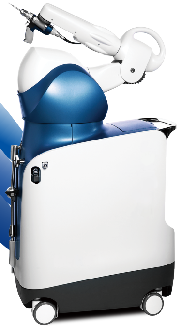
米国で開発された人工関節置換術に特化した手術支援ロボット
